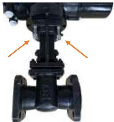
В отверстия арматуры вкрутить четыре болта тип 2 или тип 1 в зависимости от фланца арматуры. Если фланец арматуры имеет резьбовое соединение, необходимо использовать тип 2
